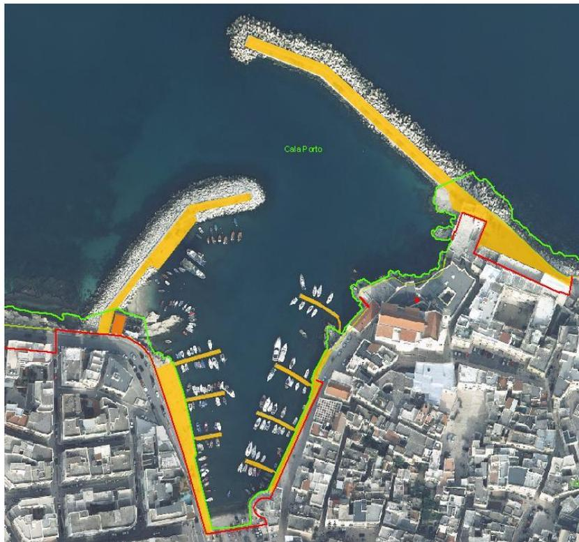
**Figura 46: Individuazione delle strutture fisse: Edifici - Moli - Pontili**
